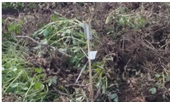
Figura 1: Imagen de un caza espora utilizado para la captura de teliosporas de T. frezii
